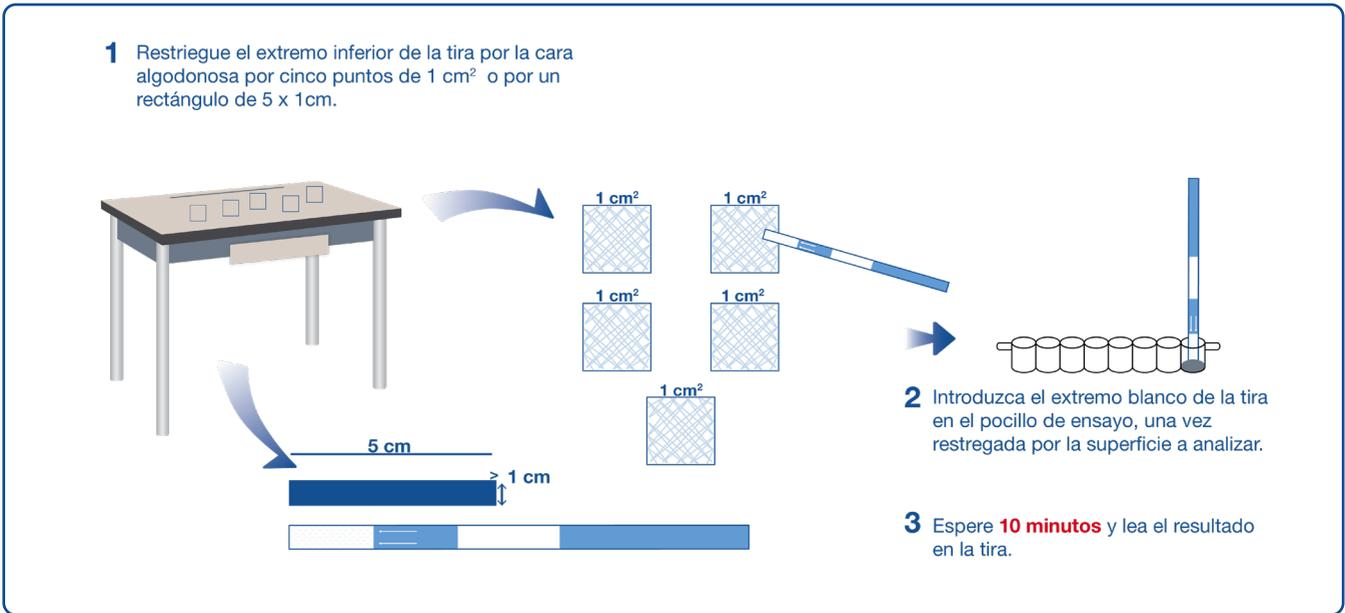
Figura 4. Esquema del procedimiento de análisis de superficies
