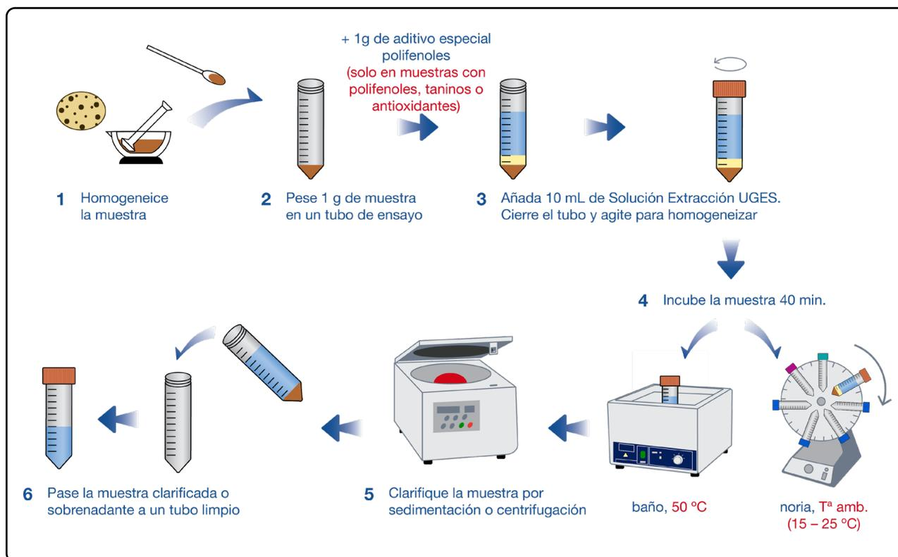
Figura 2. Esquema del procedimiento de extracción de muestras sólidas
